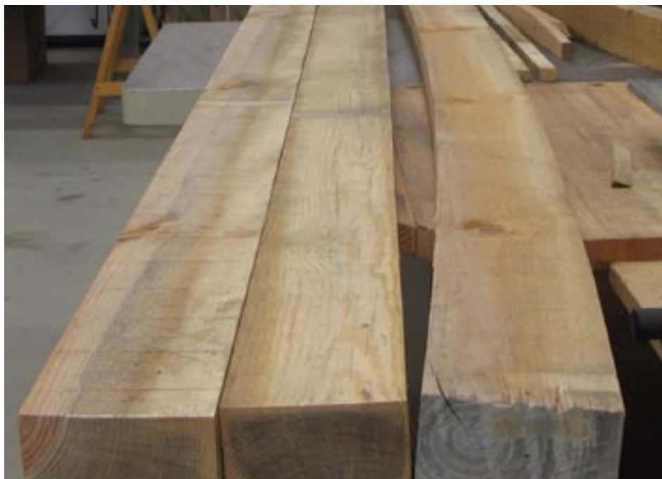
Foto 10 – Deformazione da arcuatura (primo elemento da destra), causata principalmente dal fatto che all'interno dell'elemento si trova il midollo e che questo è decentrato rispetto alla sezione.
