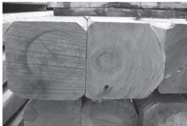
Fig. 2. Travi di castagno "Uso Fiume". Gli assortimenti vengono squadrati e successivamente piallati a mano con smusso fino alla punta, mantenendo una sezione costante. A sinistra, lavorazione effettuata con pialla a mano di travi in castagno "Uso Fiume" e, a destra, particolare di alcune sezioni con smusso
